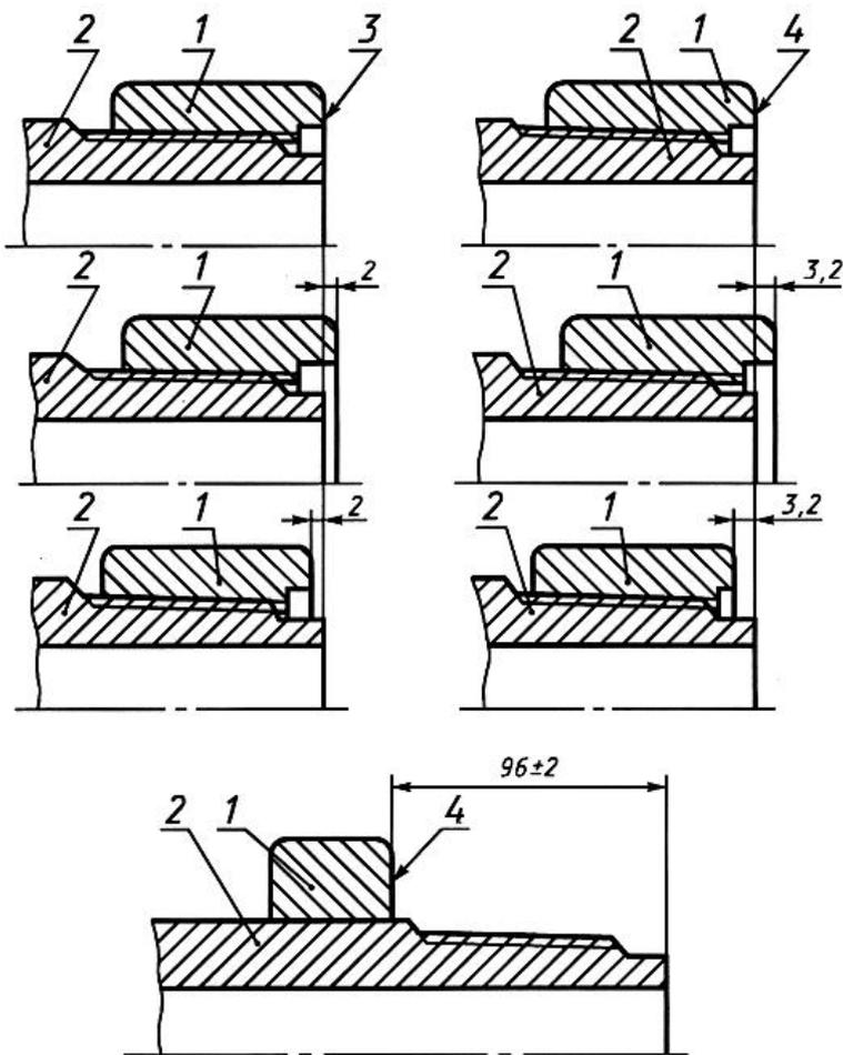
1 - кольцо; 2 - труба; 3 - измерительная плоскость резьбовых калибров с полным и неполным профилем; 4 - измерительная плоскость гладкого калибра-кольца
