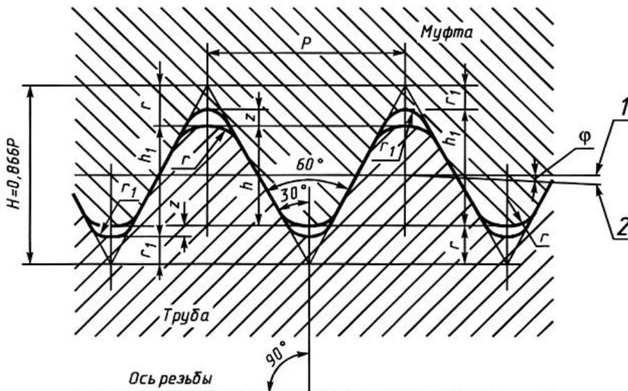
1 - линия, параллельная оси резьбы; 2 - линия среднего диаметра резьбы
